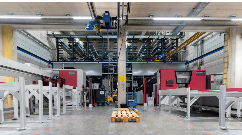
1 Das Sägezentrum besteht aus dem Hochleistungsbandsägeautomaten 'HBM540A' (links im Bild) sowie der automatischen Bandsäge 'HBE411A Dynamic'. Im Hintergrund ist das Brückenlager von Remmert zu sehen © Behringer
